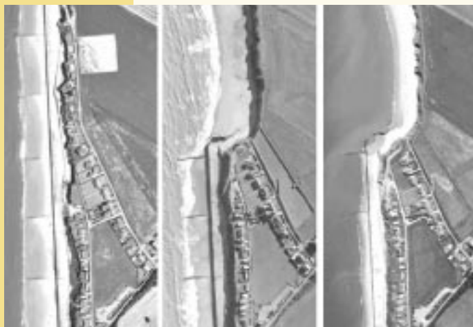
Serie de vistas aéreas de Happisburgh de 1992, 1999 y 2001. El retroceso del acantilado es fácilmente visible en la parte superior de la fotografía.
